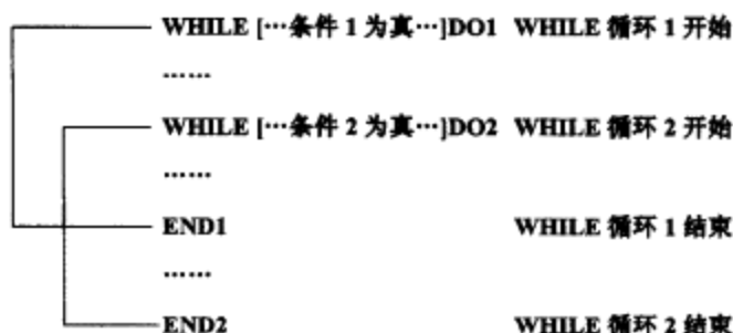
图 13.7 常见的宏程序循环错误——主要为结构问题(与前面的格式比较)
